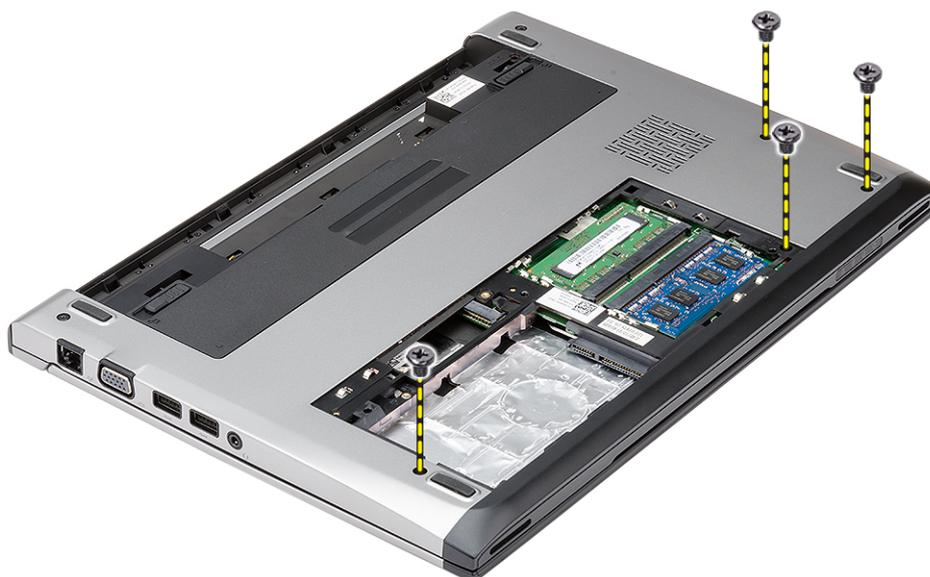
4. Retirez les vis situées sur le repose-mains.
